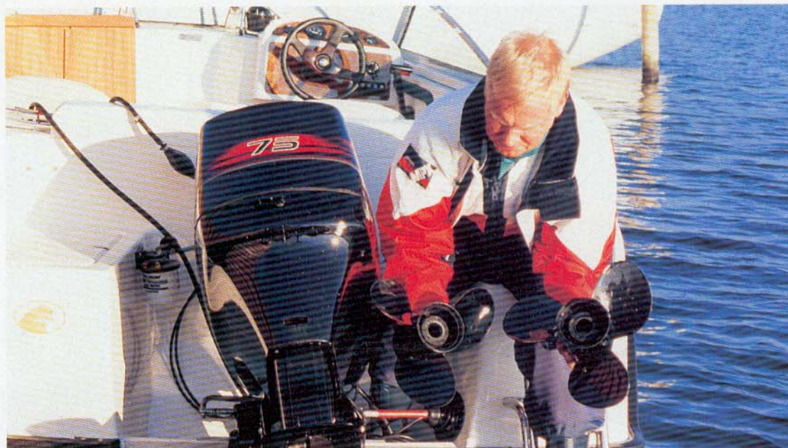
De tre aluminiumspropeller blev testet på en 75-hestes Mercury monteret på en daycruiser – Uttern 5500 DC.
