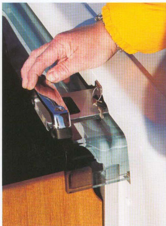
Når kahytsslugen blev lukket blev nøglen klemt og kunne let knække. Efter testen ændrede Askeladden systemet.
